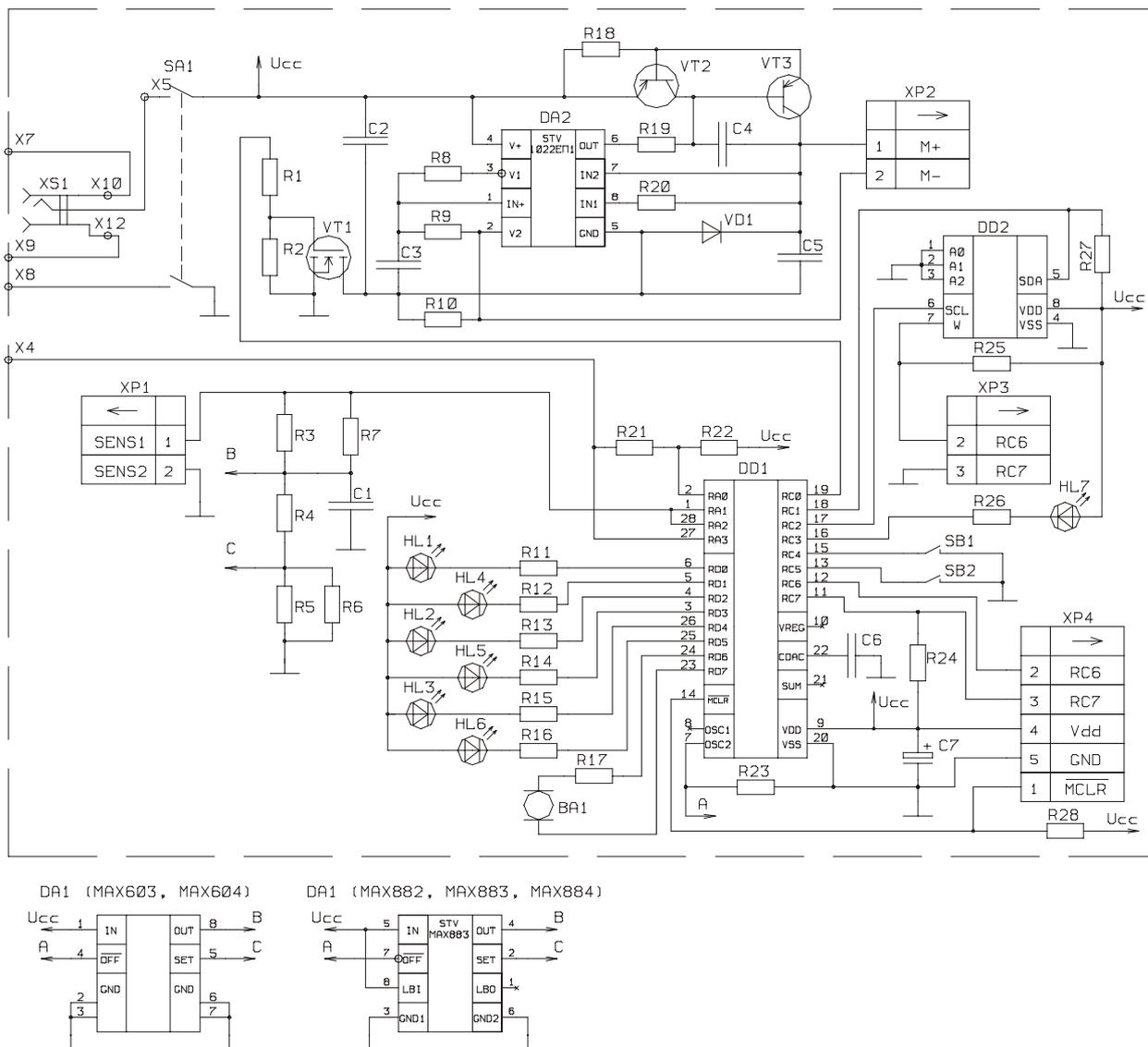
Рисунок 3.Схема электрическая принципиальная ТС-92вм. Вариант исполнения 2. ПР54.00.00.000.
